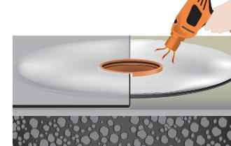
2. Cubra y pegue el disco con membrana asfáltica con métodos tradicionales.
