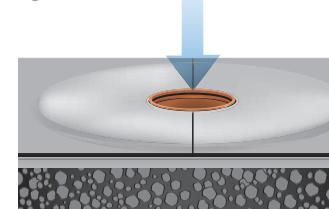
3. Recorte el excedente del tubo saliente a la longitud deseada y coloque el portarrejilla acanalado Awaduct.
