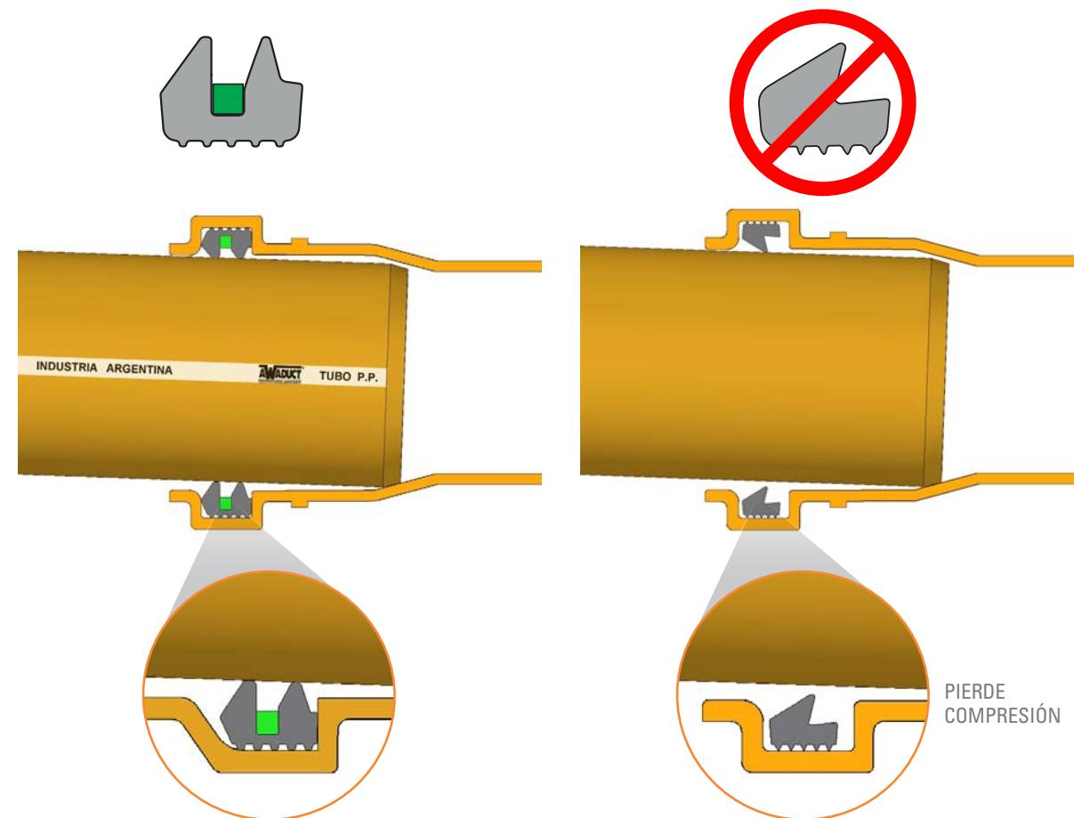
Permite ángulos en la unión y cambios de pendiente sin perder estanqueidad, gracias a que al menos un labio siempre está en contacto para asegurar la estanqueidad.
