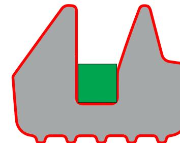
ESQUEMA DEMOSTRATIVO DE REDUCCION DE TAMAÑO DEL O´RING POR USO DE LUBRICANTES DE OTRAS MARCAS
